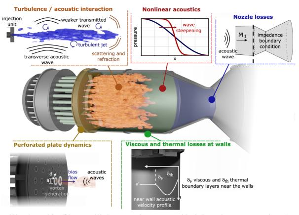
Mécanismes identifiés et modélisés comme étant responsable de l'amortissement acoustique des instabilités thermo-acoustiques dans les moteurs fusées à propulsion liquide
